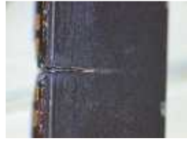
30 μm薄膜カットライン
